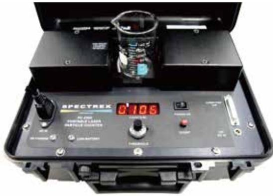
SPECTREX社製パーティクルカウンターは、1 mLあたり1,000個以下の超純水洗浄液中の微粒子測定に適しており、最大の特徴はビーカーのまま測定する点にあります。
