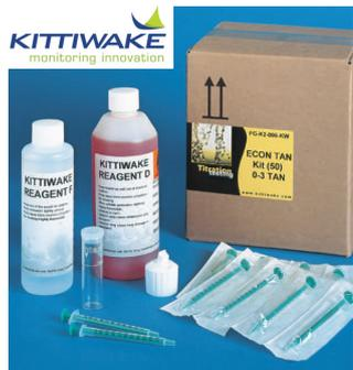
**FG-K24743-KW** TAN（酸価測定）テストは、油圧機器保全に不可欠です。油中に存在する弱有機酸及び強無機酸をTAN試験法により測定し、事前に適切な対応を促すことが可能となります。
