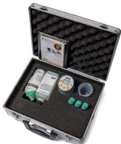
**FG-K6-004-KW+** 測定原理は、油中の添加剤塩基物質と試薬が反応してガスが発生します。使用済みオイルのガス圧と新油との低下比率で比較します。DIGI+は、一度測定した新油の発生圧力値を基準値として保存し、複数の圧力値を OIL TYPES としてメモリに保存できます。
