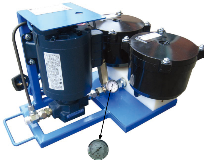
圧力ゲージにて エレメント交換時期を確認
